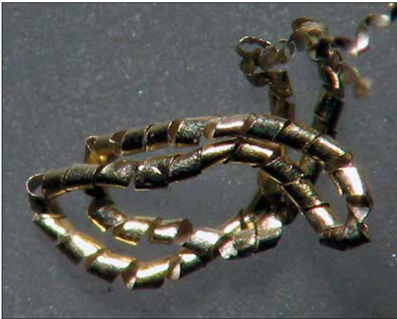
Ил. 7. Сърмените нишки през 5–6мм обръщат посоката си на 180° (микро). Pic. 7. The metal threads change directions at 180° every 5–6mm (micro).
