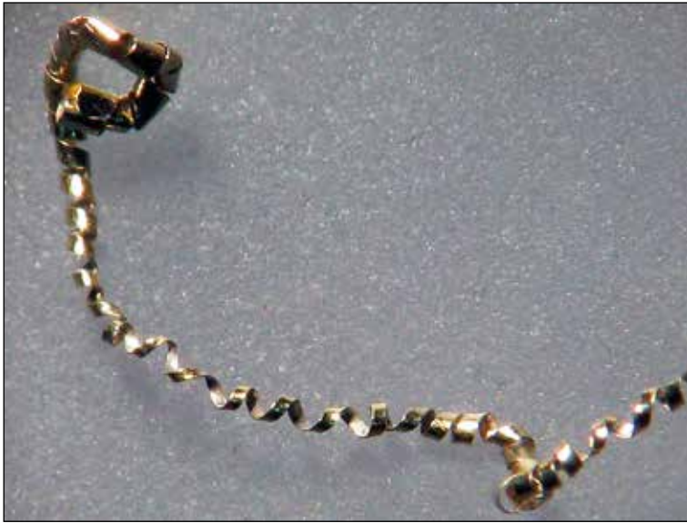
Ил. 5. Неравномерна широчина на позлатената сребърна лентичка от сърмата (микро).
