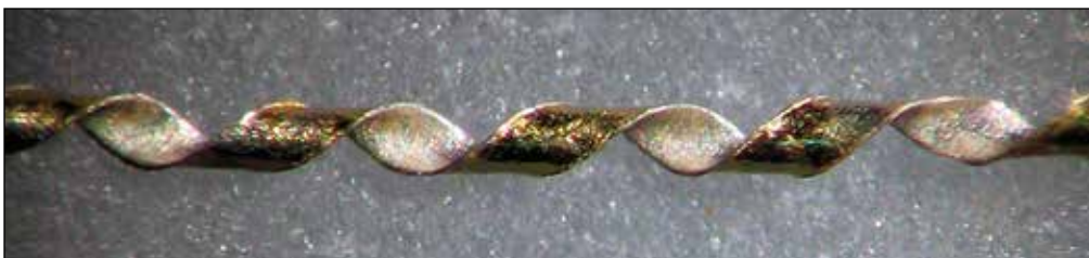
Ил. 4. Едностранна позлата на сребърните лентички от сърмата (микро).
