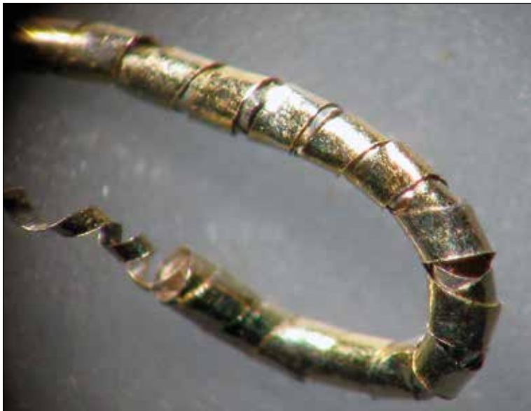
Ил. 6. Снаждането на металните лентички при усукването им около текстилното ядро (микро).
